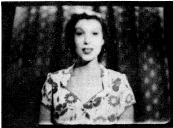
FIG. 14. POOR E.H.T. REGULATION
